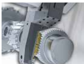
■ Taillage d'engrenages avec fraise-mère (Flanx-Hob)
